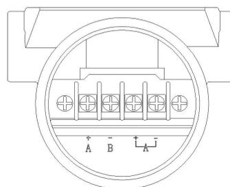
RS485 接口型变送器用于 RS485 通讯 (MODBUS-RTU 协议) 时的电气连接方法如下图所示。
